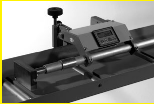
Abbildung oben: Rollenbahn mit digitaler Messeinrichtung
